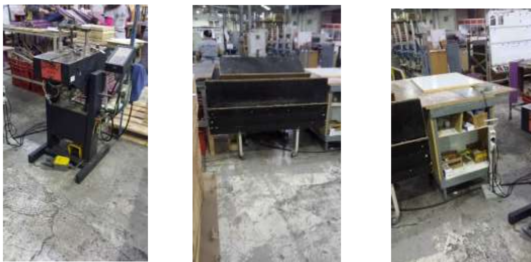
Figura 15 – Máquina de agramos e mesas de apoio de montagem manual, respetivamente nesta sequência
