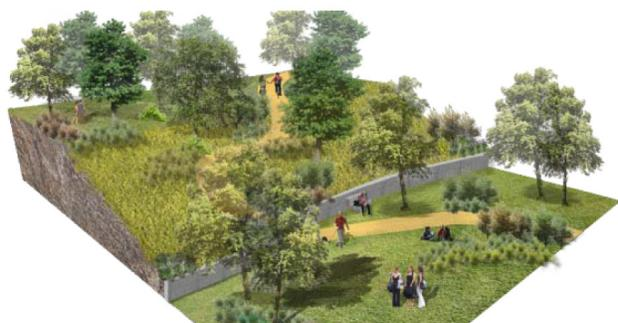
Fig. 6. Taludes suavizados com a colocação de material inerte proveniente da exploração.
