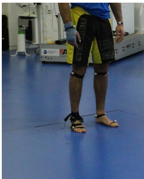
Figura 10. Posição dos pés e dos marcadores na avaliação do equilíbrio postural em plataforma de forças em superfície firme
