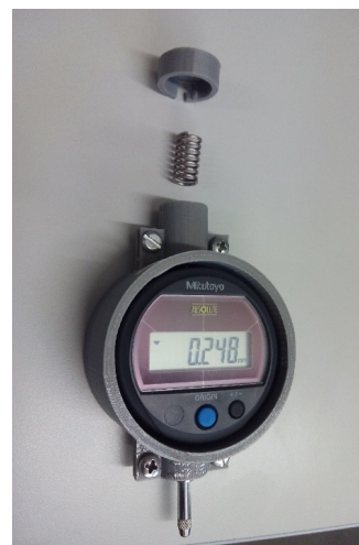
Fig. 19: Protótipo obtido por impressão 3D.
