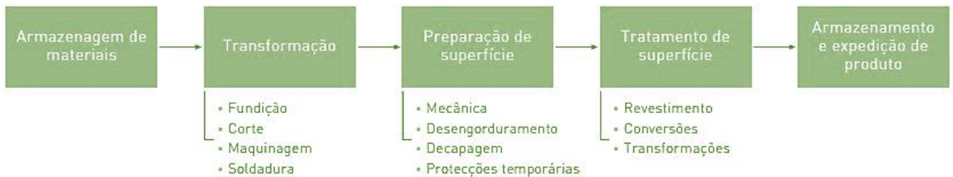
Figura 2. Fluxograma geral da indústria metalomecânica (Eurisko, 2007).
