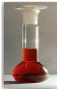
Figura 20 – Imagem de uma amostra da solução coloidal de AuNPs resultante da síntese pelo método de redução pelo citrato (Soares, 2009).
