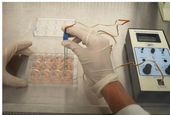
**Figura 7** – Imagem ilustrativa do processo de medição da TEER, em células cultivadas em sistema de cultura polarizada.
