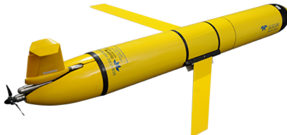
Figura 1.4: Slocum Battery da Webb Research Corp
