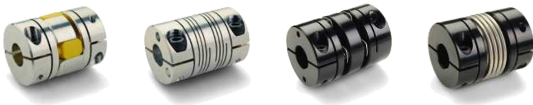
Figura 3.17 – Acoplamentos flexíveis para acionamento de eixos (elastómero, ranhura helicoidal, disco e fole respetivamente) 2
