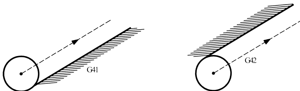
Figura 4.21 – Efeito do uso das funções de compensação do raio da ferramenta G41 e G42 [3]
