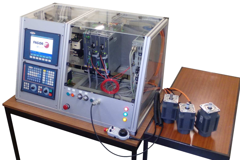
Figura 2.1 – Sistema de comando numérico e servomotores
