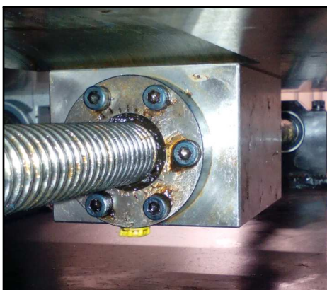
Figura 3.10 – Porca INA KGF-N montada num dos fusos da mesa XY
