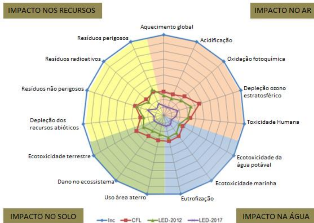
Figura 15 Impacto comparativo do ciclo de vida de uma lâmpada por tecnologia e tipo de impacto (adaptado de DoE, 2012)
