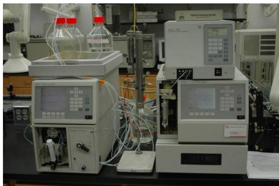
**Figura 7 - Equipamento de HPLC (adaptado de <sup>28</sup>)**
