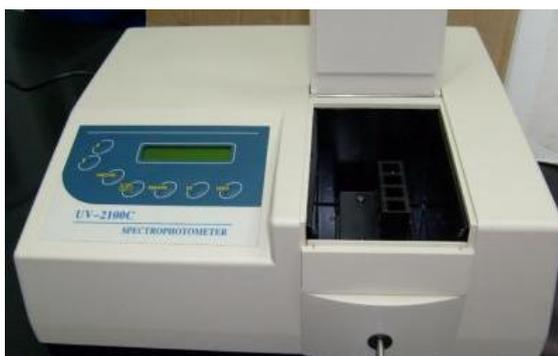
**Figura 6 - Espectrofotômetro de UV-VIS (adaptado de <sup>45</sup>)**
