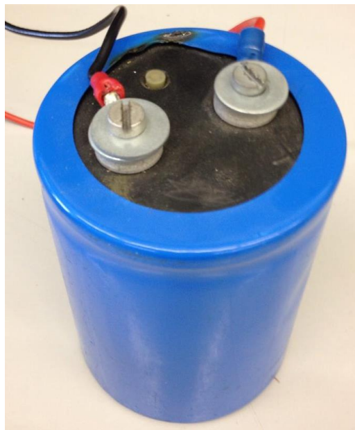
Figura 5.18 - Condensador de 3300 \mu\text{F} com tensão de funcionamento máxima de 400V.
