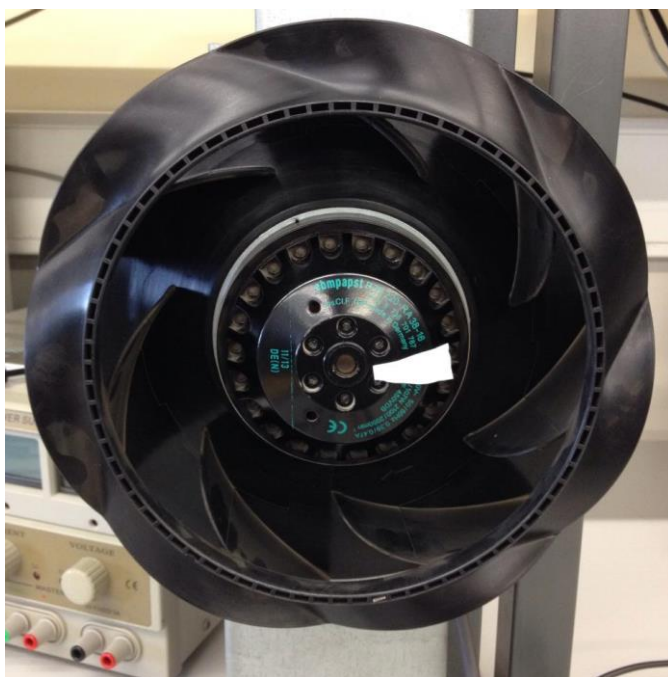
Figura 5.22 - Ventilador monofásico de 230V e 107W.
