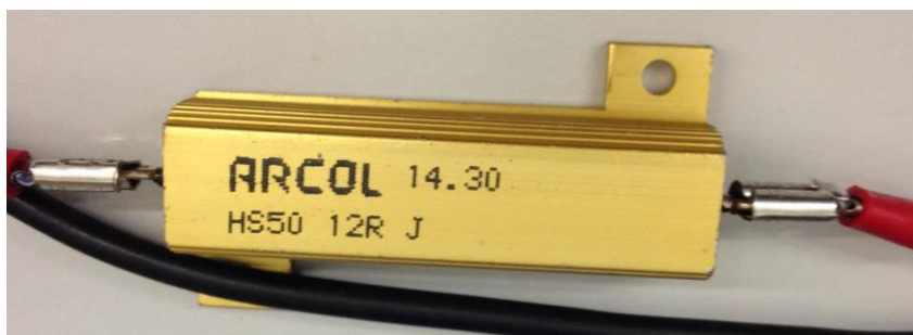
Figura 5.20 - Resistência de potência (com dissipador) de 12 \Omega e 50W.
