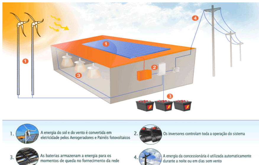
Figura 3.3 - Esquema exemplificativo de um sistema híbrido [16]
