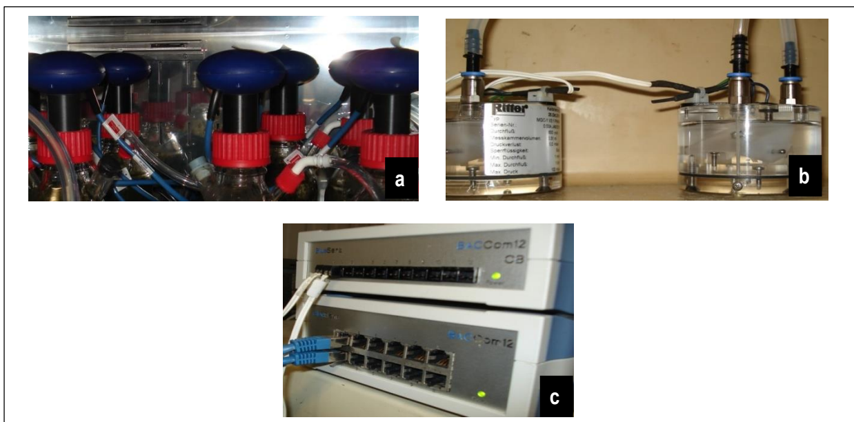
Figura 3.3 – Fotografias de alguns elementos da instalação experimental utilizada: (a) sensores óticos BCP-CH4; (b) MilliGascounter® MGC-1; (c) caixa de conexão BACCom 12 em modo de funcionamento.
