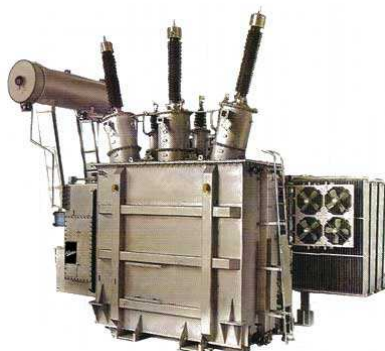
Figura 3.14 - Transformador de potência trifásico, com o tanque de expansão à esquerda em cima e os radiadores com ventoinhas à direita em baixo [24].
