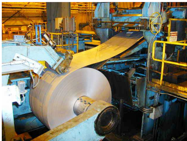
Figura 3.16 - Exemplo de laminagem de frio [27].
