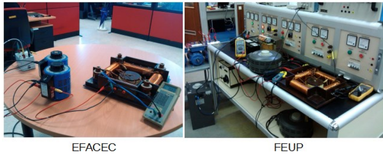
Figura 5.7 - Montagem da ponte de Epstein com a aparelhagem de alimentação elétrica e de medição das características elétricas, nas instalações da Efacec e da FEUP.
