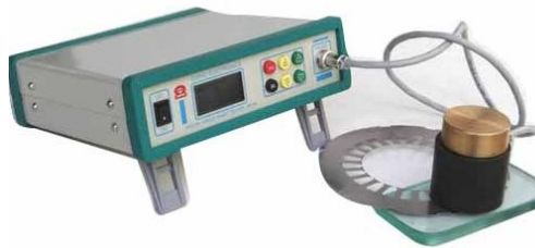
Figura 5.6 - Exemplo de aparelho digital para teste de chapa única [65].
