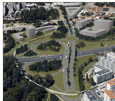
fig. – (referencia web 8) Controle da velocidade no nó da Via Norte para introdução de duas rotundas, estabelecendo melhor articulação com os acessos envolventes, e supressão de duas ramificações relocalizando-as no lado oposto, diminuído a area de conflitos e fragmentos vazios/inacessíveis. Inserção de novos equipamento que tirem proveito da acessibilidade na espectativa de gerarem novos processos construtivos que moderem, valorize e se integrem com a malha envolvente.
