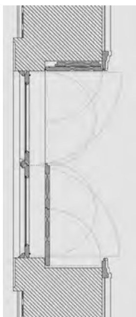
53,54. Corte vertical e horizontal e de uma janela de sacada e batente
