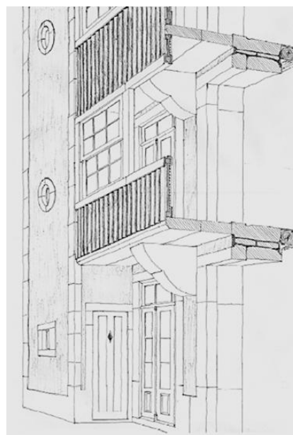
46. Corte transversal por uma fachada abrangendo janela de peito e janela de sacada
