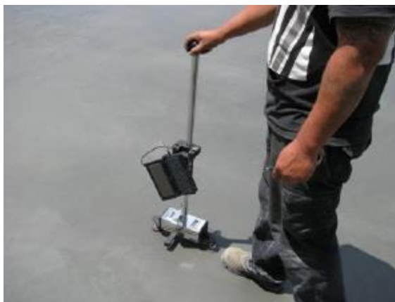
Fig. 3.9 – Equipamento para medição de nivelamento e planura do pavimento [33].
