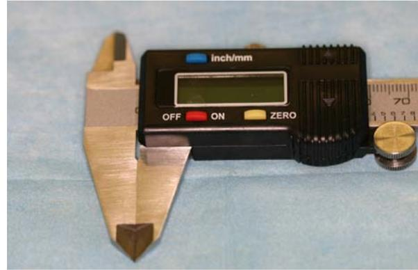
Ilustração 41 - Paquímetro digital Fischer Darex®
