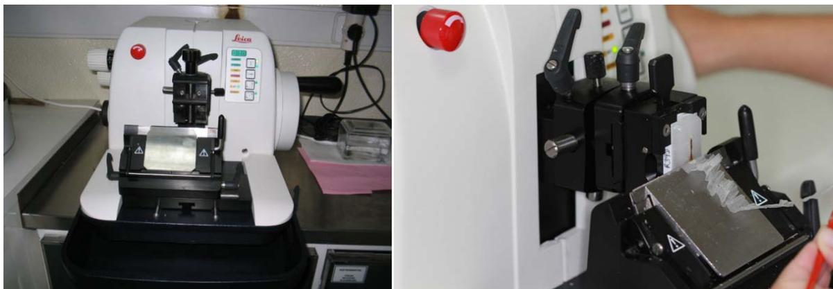
Ilustração 78 - Micrótomo – Leica RM 2155, Leica - Portugal
