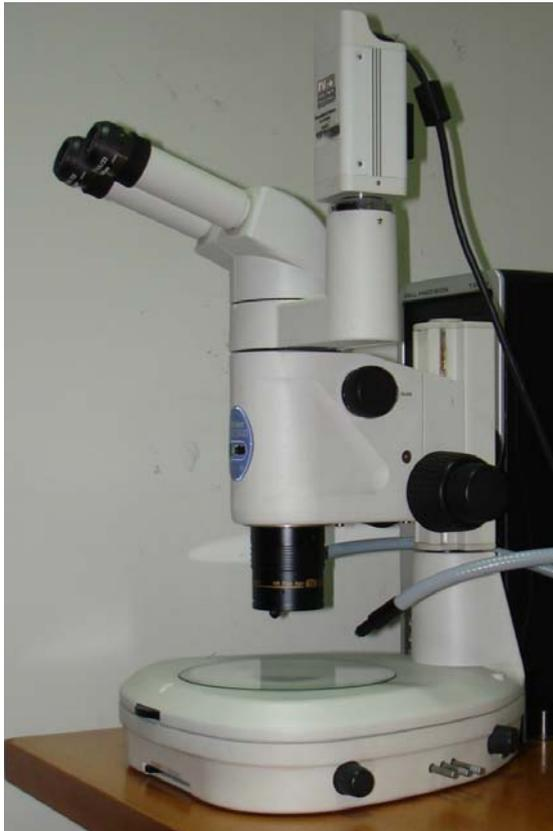
Ilustração 97 - Estereomicroscópio binocular Nikon®
