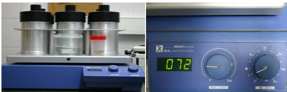
Ilustração 70 - Unidade de desidratação e infiltração contendo as amostras (vista frontal)
