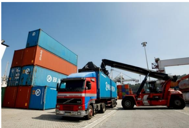
Fig.10 – Colocação de contentor portuário em camião
