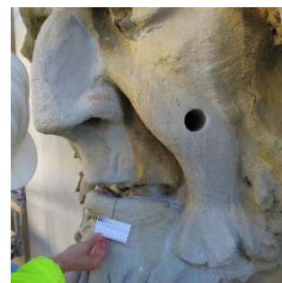
Figura 5.39 – Extração de carote na face.
