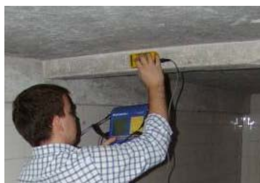
Figura 4.40 – Detecção de armaduras com o Profometer 5.
