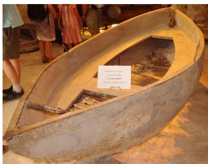
Figura 3.6 – Barco de ferrocimento construído por Joseph Lambot, adaptado de (Wikipedia, 2015c).
