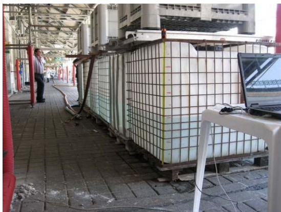
Figura 4.49 – Enchimento de reservatórios no ensaio 2 no local A.
