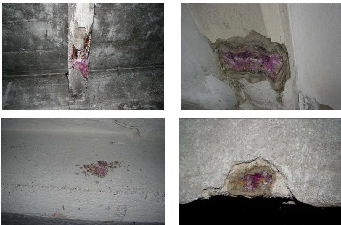
Figura 4.45 – Exemplos do teste com o indicador químico de fenolftaleína.
