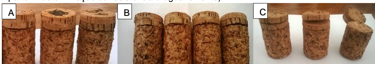
Figura 15 - Rolhas após o teste de ebulição. A - Pontos de descolagem; B - Descolagem Parcial; C - Descolagem Total
