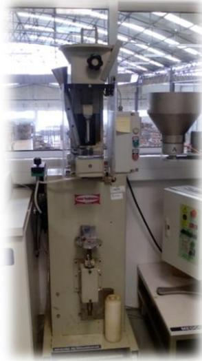
Figura 32– Ensaio de determinação da taxa de recuperação das rolhas de cortiça
