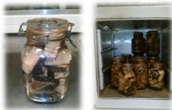
Figura 20 – Preparação amostras para quantificação de TCA nas aparas de cortiça
