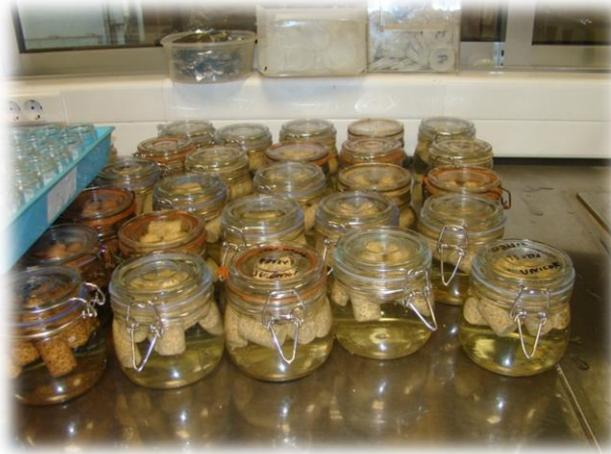
Figura 22 – Preparação amostras para quantificação de TCA nas rolhas de cortiça
