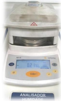
Figura 26 – Analisador automático de humidade do granulado
