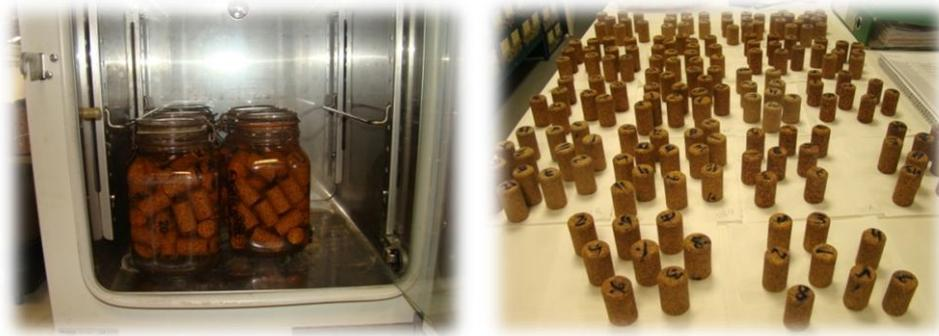
Figura 29– Ensaio da determinação da percentagem de absorção das rolhas
