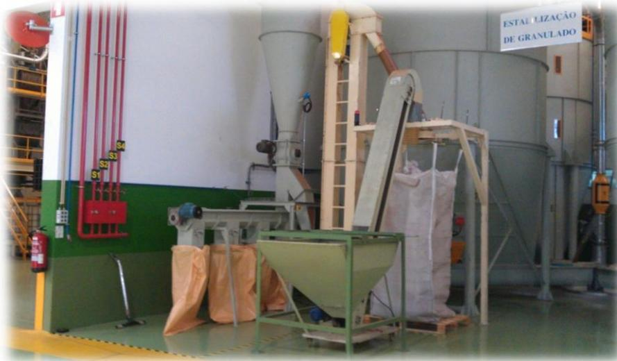
Figura 11 – Zona de estabilização do granulado RN após passar pelo secador
