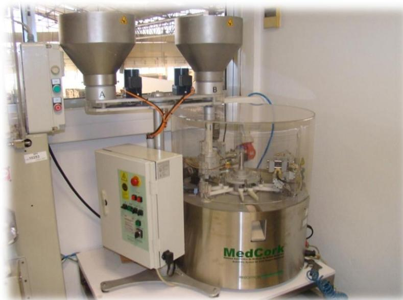
Figura 28– Ensaio de medição das dimensões, massa, massa volúmica e humidade das rolhas no Medcork
