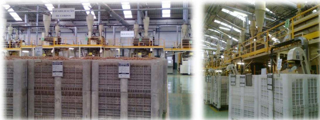
Figura 12e 13 – Processo de produção das rolhas técnicas através da moldação
