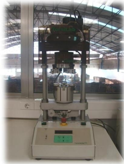
Figura 33–Torsiómetro utilizado na torção
