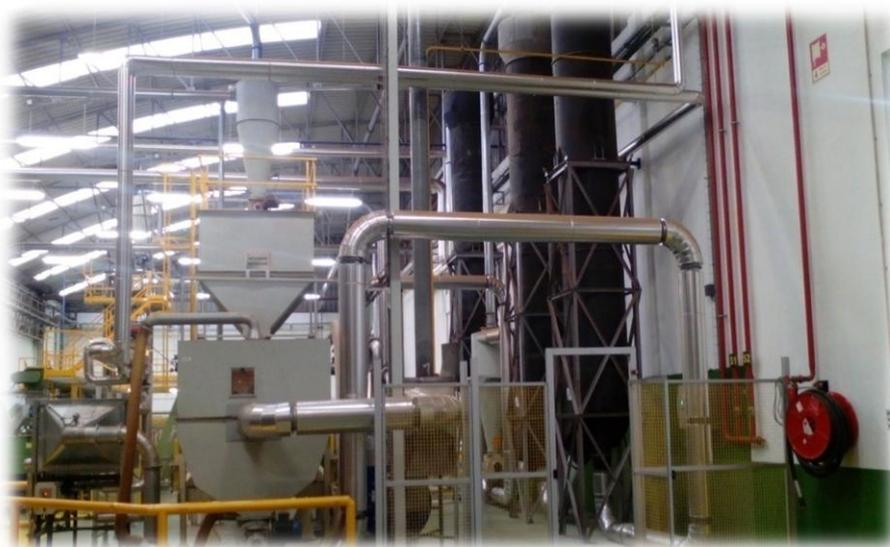
**Figura 10 – Zona de secagem do granulado RN após passar pelo sistema ROSA (secador)**
