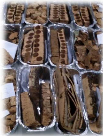
Figura 24 – Determinação da humidade da aparas
