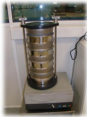
Figura 27 – Agitador de peneiros utilizado para realização do ensaio de granulometria.
