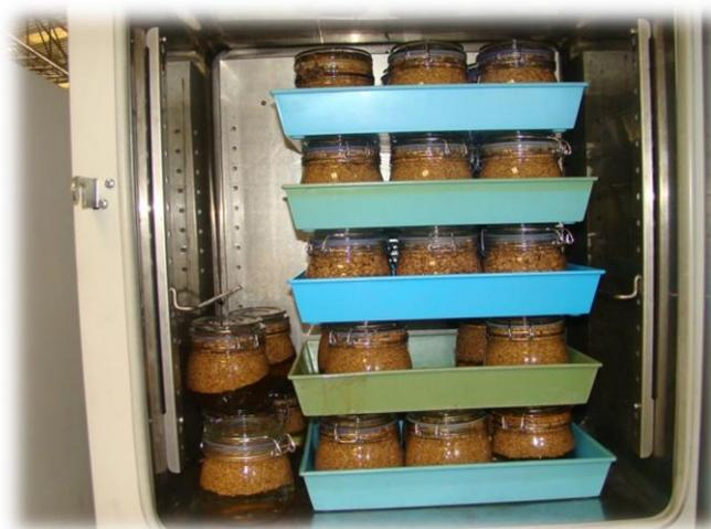
Figura 21 – Preparação amostras para quantificação de TCA nos granulados de cortiça
