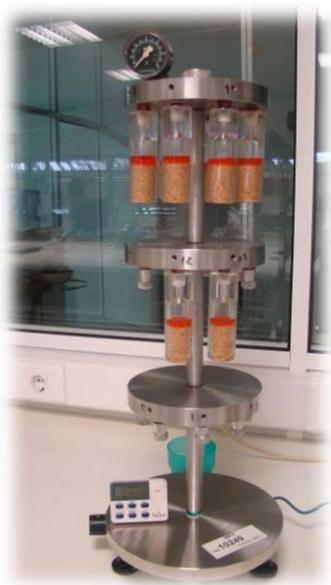
Figura 31– Ensaio de vedação ao líquido
