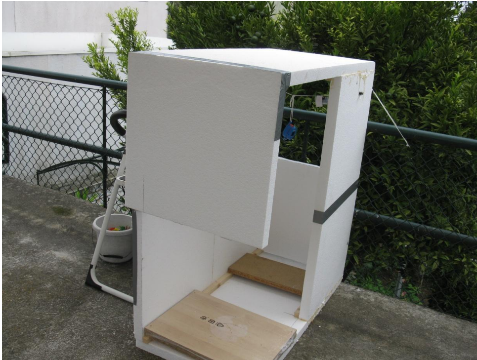
Figura 53 – Detalhe do abrigo em esferovite, de grandes dimensões (1m x 1m x 0,5m) e munido de aberturas amplas, especialmente concebido para albergar sondas térmicas provenientes dos abrigos de outros postos, colocado à sombra junto do Posto A-Tejo.
