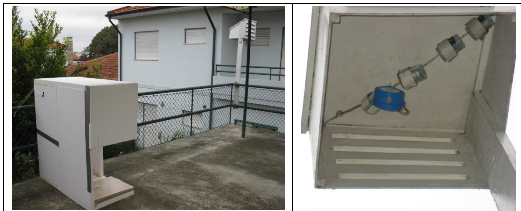
Figura 52 – Posto A-Tejo: enquadramento do abrigo especial e do abrigo do posto A (lado esquerdo); pormenor do abrigo do posto A, exposto ao sol durante grande parte do dia, com as cinco sondas em conjunto (lado direito).
