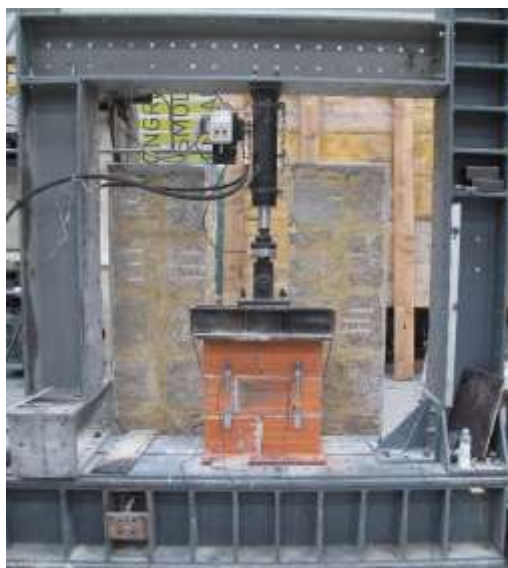
Figura 4.5 – Pórtico utilizado e murete de 600 x 600 mm 2 posicionado para ensaio à compressão
