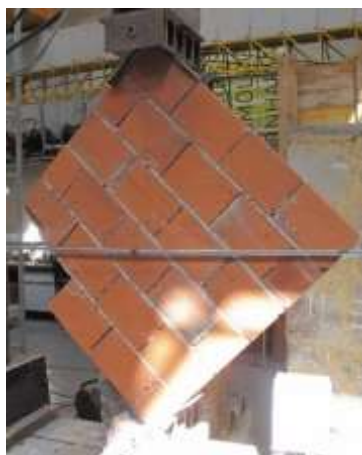
Figura 4.13 – Reutilização do provete A do tipo “CD11”, por rotação de 90°
