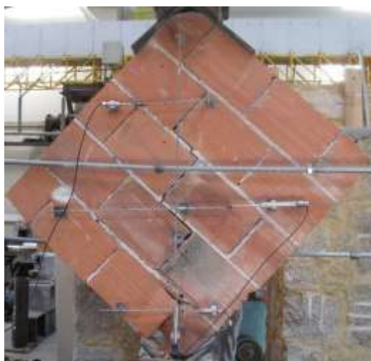
Figura 4.16 – Rotura por deslizamento/destacamento diagonal do murete A (alterado) do tipo “CD11”.
