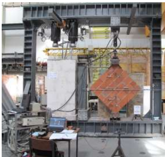
Figura 4.11 – Instrumentação, pórtico e murete utilizados no ensaio de compressão diagonal.
