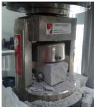
Figura 4.3. – Ensaio à compressão de provetes de argamassa.
