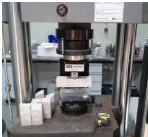
Figura 4.2. – Ensaio à flexão de provetes de argamassa.
