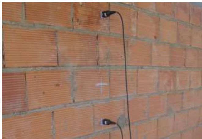
Figura 5.9 – Ligação entre os acelerómetros e os tijolos.
