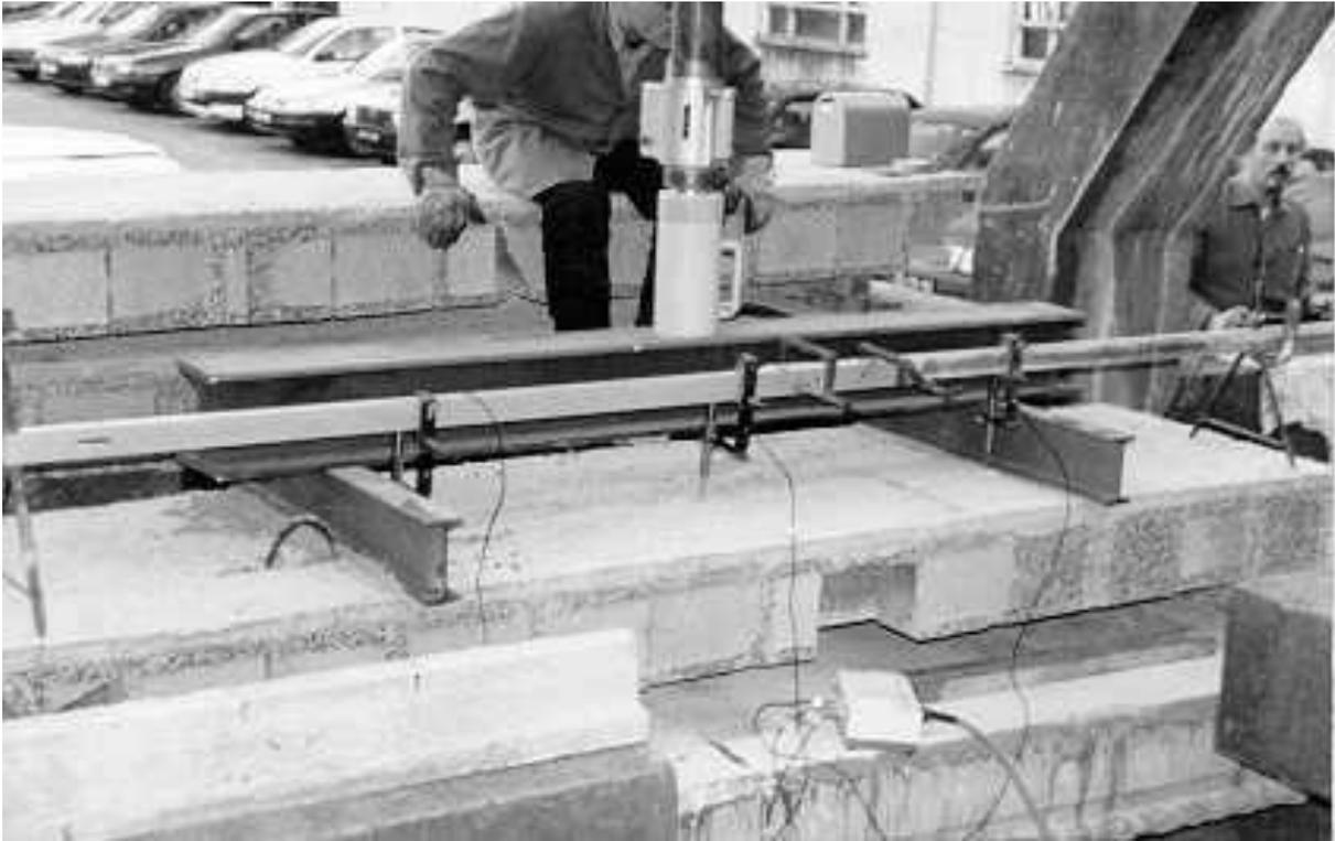
Fig. 5.8 – Ensaios sobre lajes Pavileca
