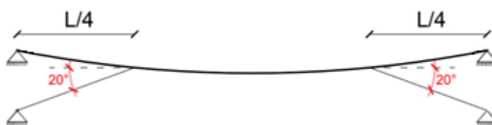
Figura 3.32 - Configuração do cabo com espigas a L/4 do vão com inclinação de 20^\circ .
