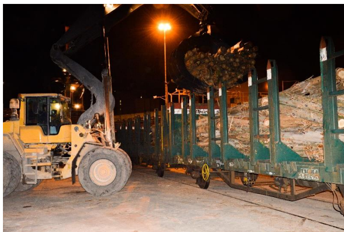
Figura 4.2 - Remoção de uma estiva de madeira do veículo.
