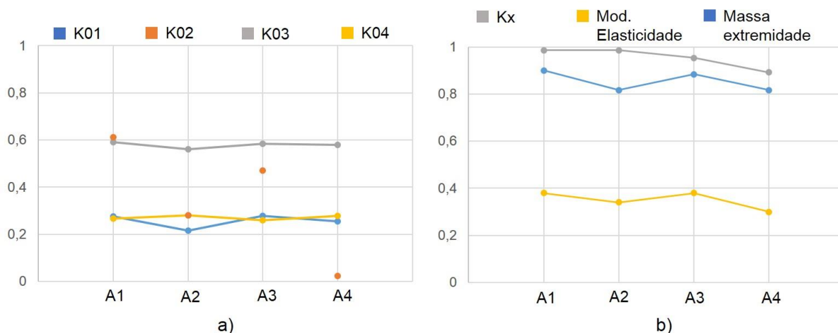
Figura 4.35 – Rácio dos valores dos parâmetros em relação aos limites. a) Parâmetros de rigidez das suspensões; b) restantes parâmetros.
