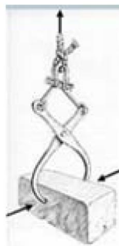
Fig. 24 – Detalhe do funcionamento e das marcas do fórflex [4]
