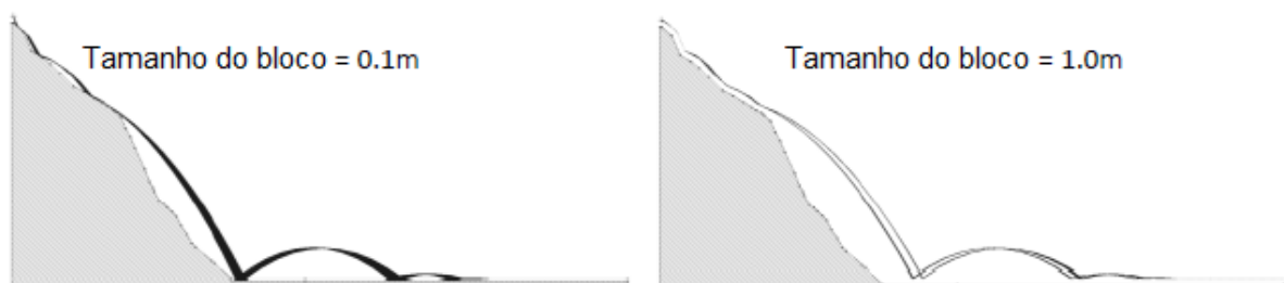
Fig 4.12 – Análise de queda de blocos para diferentes tamanhos – coeficiente de atrito \mu=0 , V_x=1 , desvio padrão=0.1, R_n=0.4 (Vijayakumar et al., 2011)
