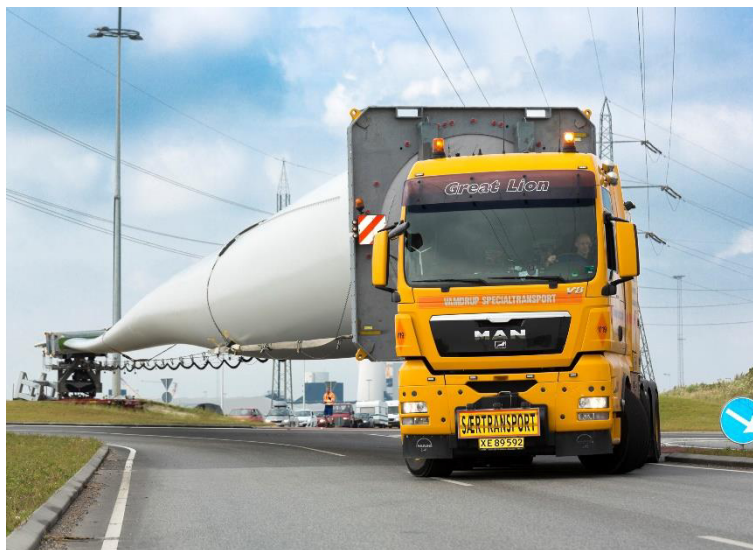
Fig. 25 – Transporte por via terrestre da Pá de um aerogerador (Siemens AG 2012)
