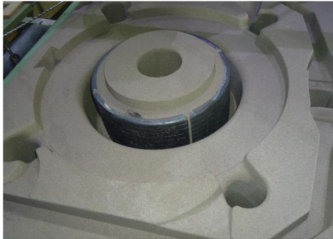
Figura 2: Arrefecedores utilizados na moldação. Existem também arrefecedores na base da peça, que não estão visíveis.
