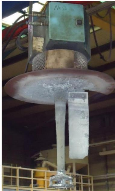
Figura 1: Equipamento de desgaseificação utilizado na Firmago.
