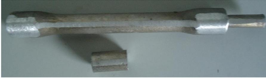
Figura 33: Provete seccionado para a realização do tratamento térmico T6 e ensaio mecânico de dureza.
