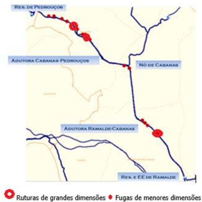
Figura 12 - Locais onde ocorreram ruturas de grandes dimensões e fugas de menores dimensões no sistema adutor entre Ramalde e Pedrouços
