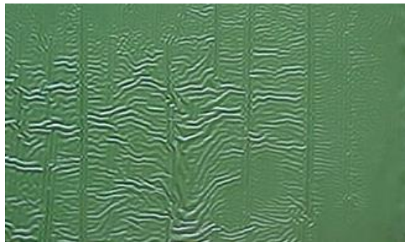
Fig.3.5 - Película de tinta enrugada [29].
