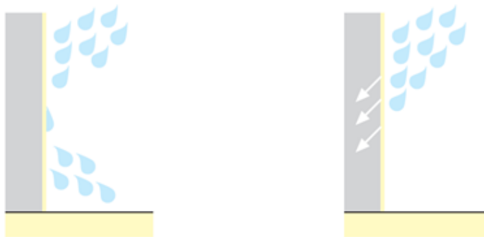
Fig.3.20 - Esq.- Fachada onde foi aplicada tinta impermeabilizante à água da chuva; Dta.- Fachada onde foi aplicada tinta não impermeabilizante à água da chuva.
