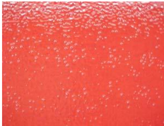
Fig.3.8 - Após aplicação da tinta, aparecimento de espuma na película de tinta [29].
