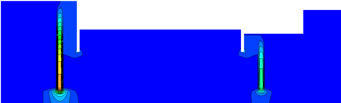
Fig. 4. 56 - Esquema da distribuição dos gradientes hidráulicos
