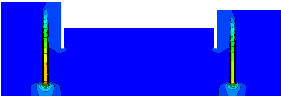
Fig. 4. 30 - Esquema da distribuição dos gradientes hidráulicos
