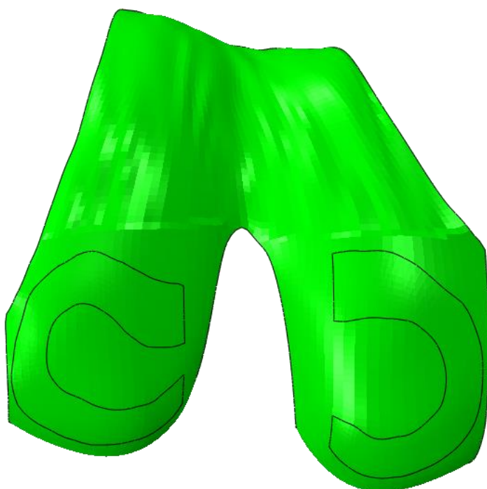
Figura 62 - Definição da superfície de contacto entre a cartilagem femoral e os meniscos medial e lateral.
