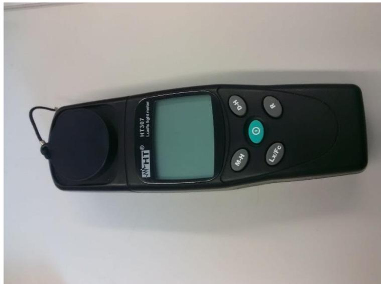
**Figura 2.5** - Luxímetro HT307 utilizado para medição de iluminância
