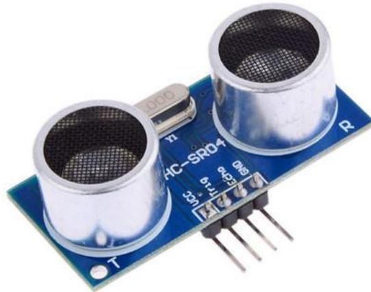
**Figura 4.2** - Exemplo de sensor ultrassónico [14]
