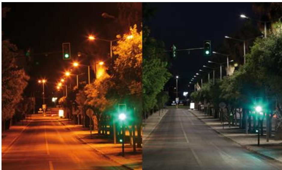
Figura 5.1 - Diferença entre as lâmpadas de vapor de sódio (à esquerda) pela tecnologia LED (à direita) na cidade de Reguengos de Monsaraz [98]
