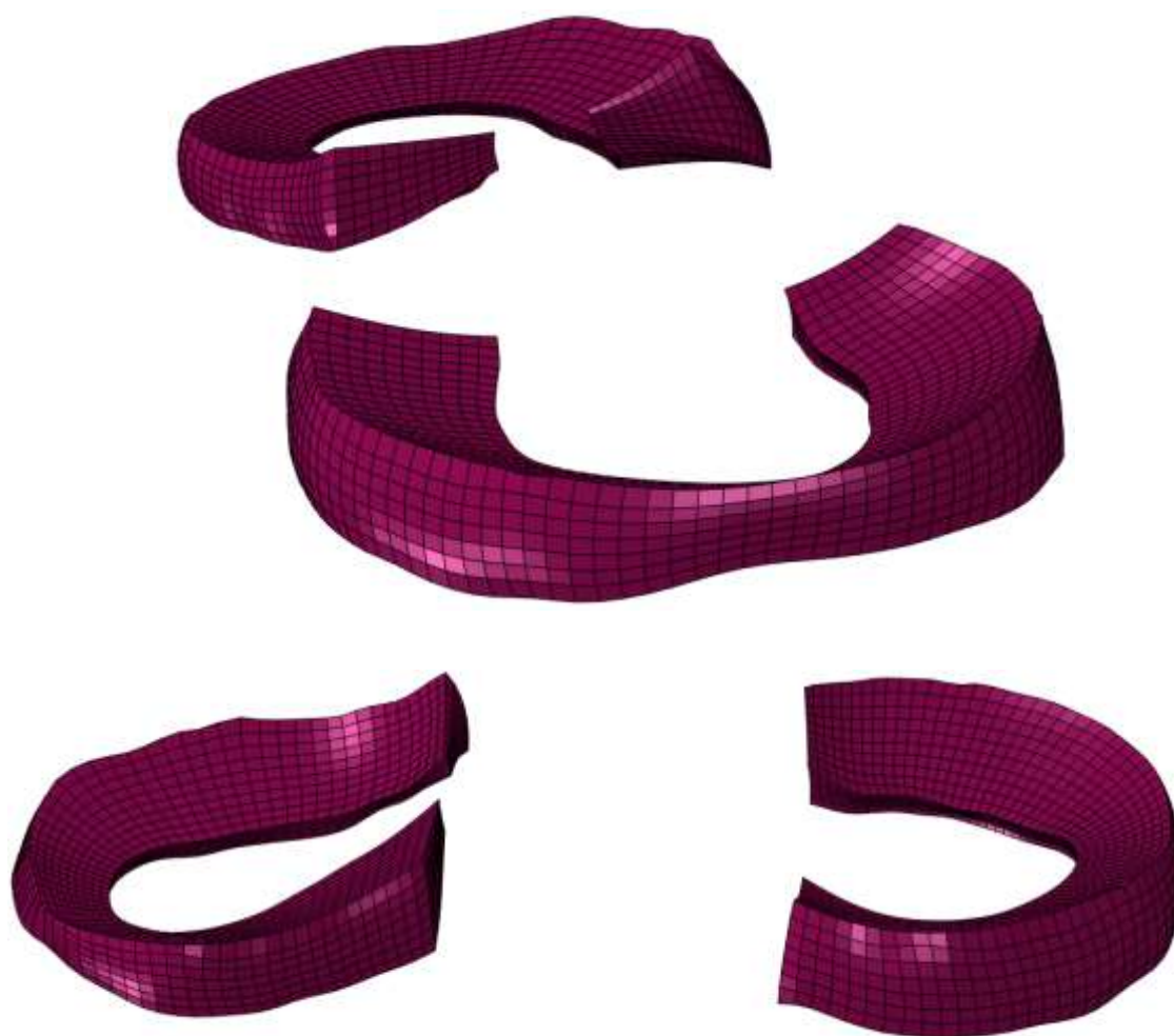
Figura 4.10 - Malha de elementos finitos dos meniscos lateral e medial
