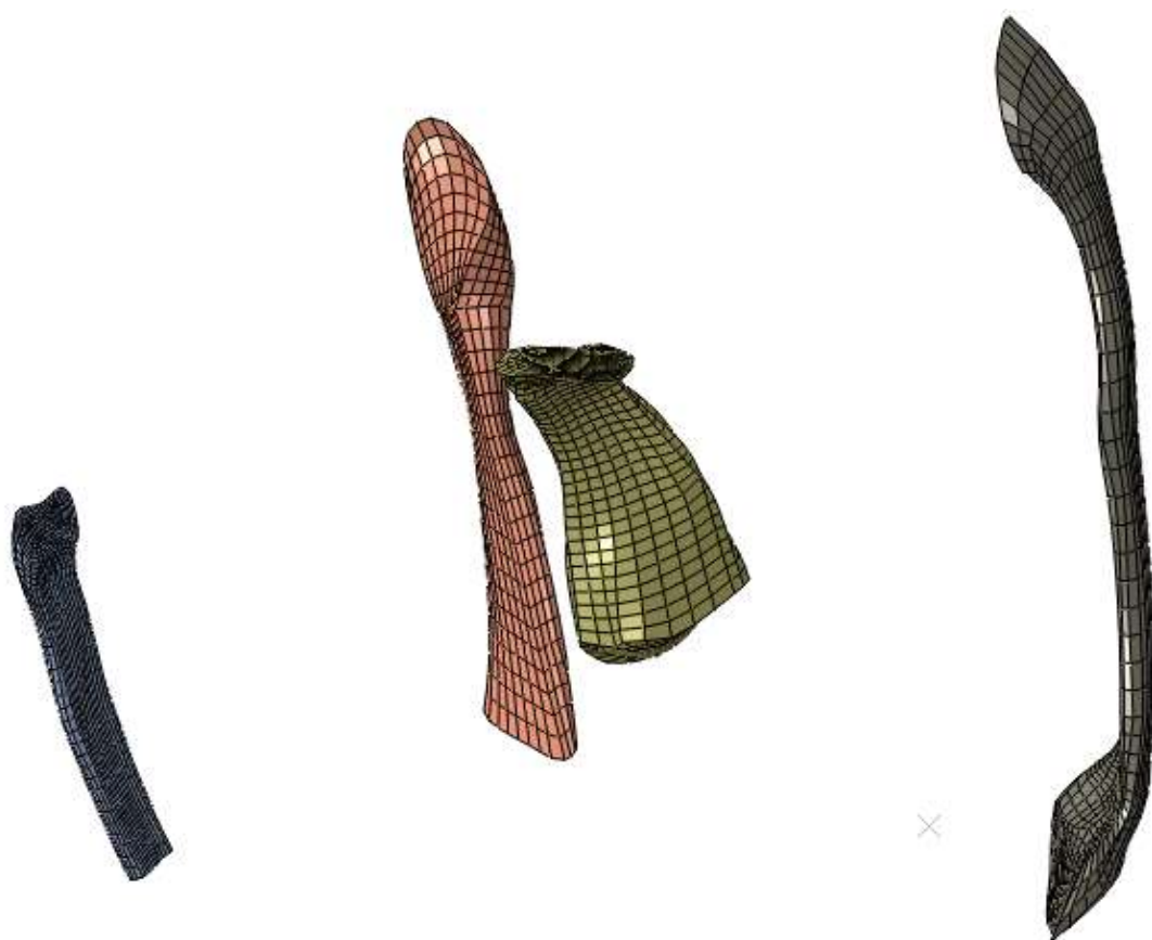
Figura 4.9 - Malha de elementos finitos das matrizes dos ligamentos
