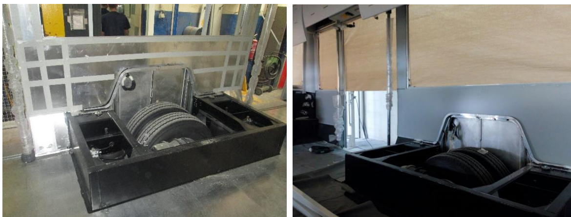
Figura 14- Estado da unidade COBUS antes e depois da aplicação da laminite.
