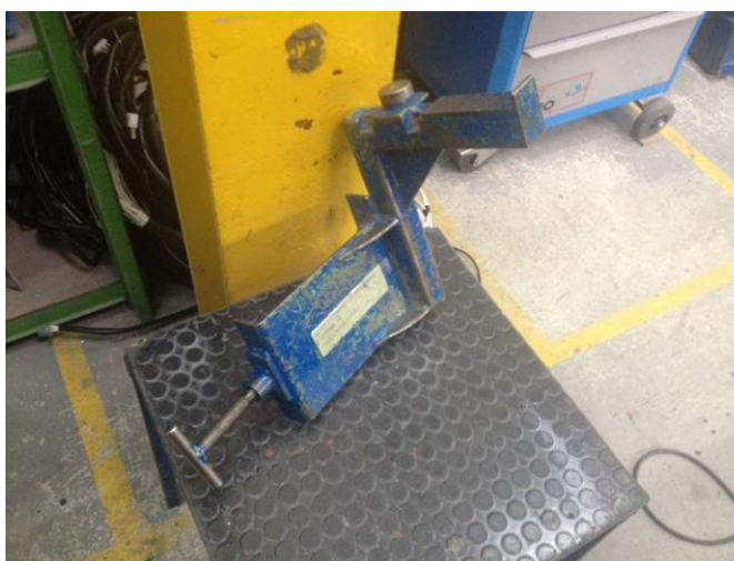
Figura 17- Meio auxiliar de produção usado no posto 3 para fixação das travessas.
