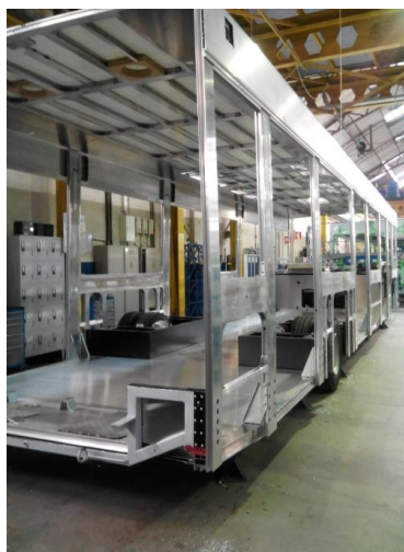
Figura 12- Painéis laterais já montados no chassis e tejadilho.
