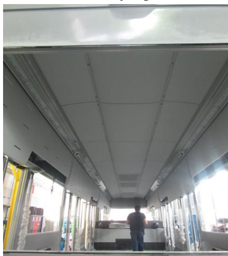
Figura 15- Nesta imagem denota-se as sancas já aplicadas na unidade COBUS.
