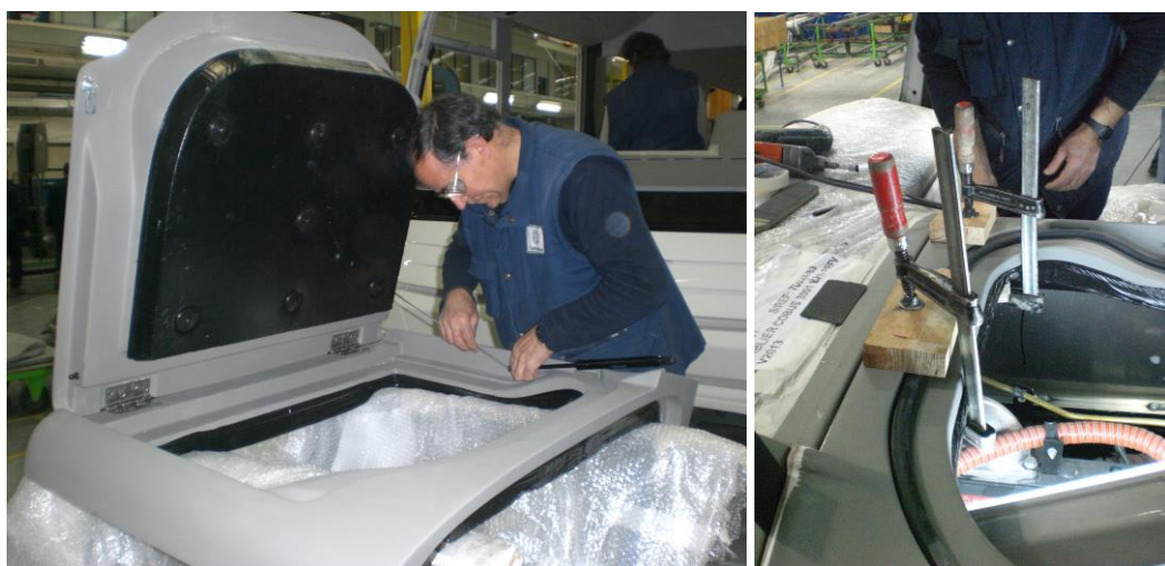
Figura 16- Montagem do capo.
