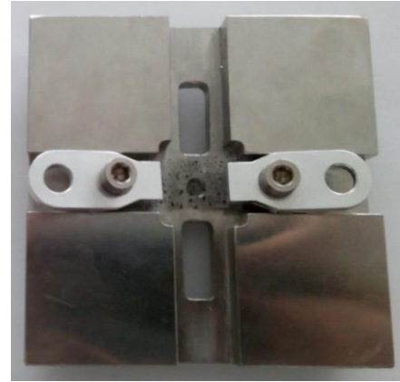
Figura 4.5 - Montagem de provete de PDMS
