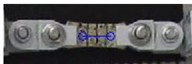
Figura 5.13 - Provete utilizado no ensaio a 10 mm/min e pixels de referência iniciais
