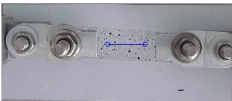
Figura 6.5 - Posições de referência para PDMS liso. 1: pontos afastados; 2: pontos próximos
