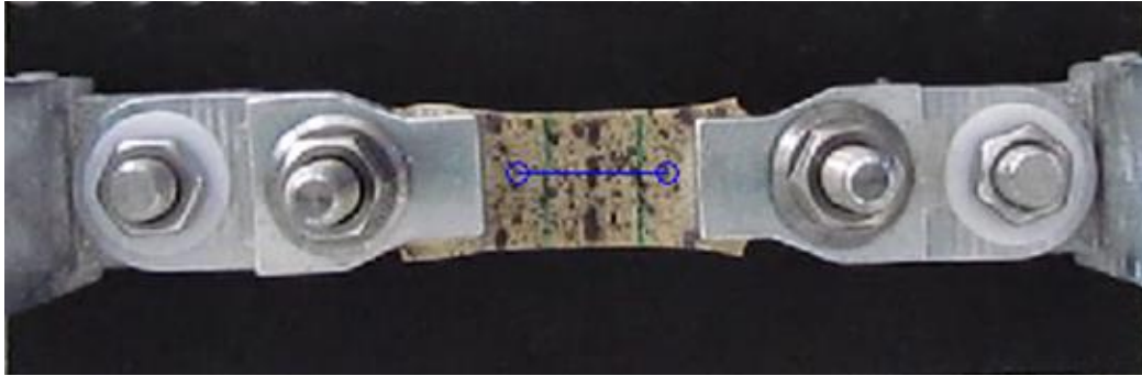
Figura 4.10 - Representação dos pixels de referência e segmento de reta inicial, de comprimento l_i pixels (a azul)
