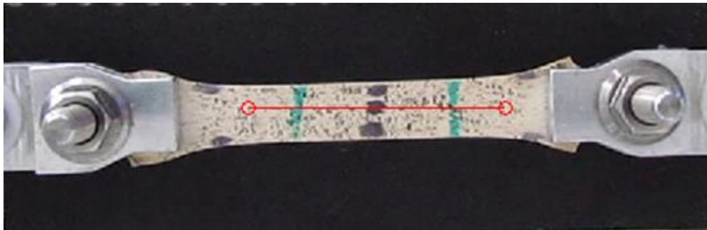
Figura 4.11 - Representação dos pixels de referência e segmento de reta final, de comprimento l_f pixels (a vermelho)
