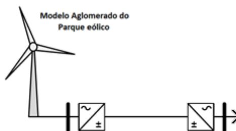
Figura 3.1 - Representação simplificada da ligação HVDC
