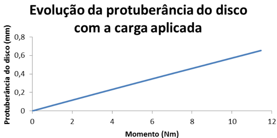
Figura 7.31 - Evolução da protuberância do disco com a carga aplicada
