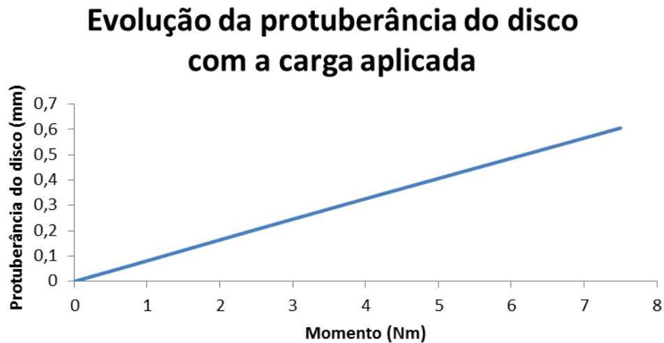
Figura 7.28 - Evolução da protuberância do disco com a carga aplicada (flexão lateral)
