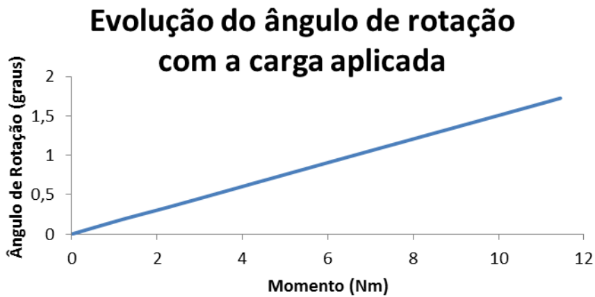
Figura 7.30 - Evolução do ângulo de rotação com a carga aplicada
