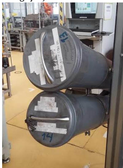
Figura 16- Tubos de abastecimento na parte traseira de um posto de trabalho
