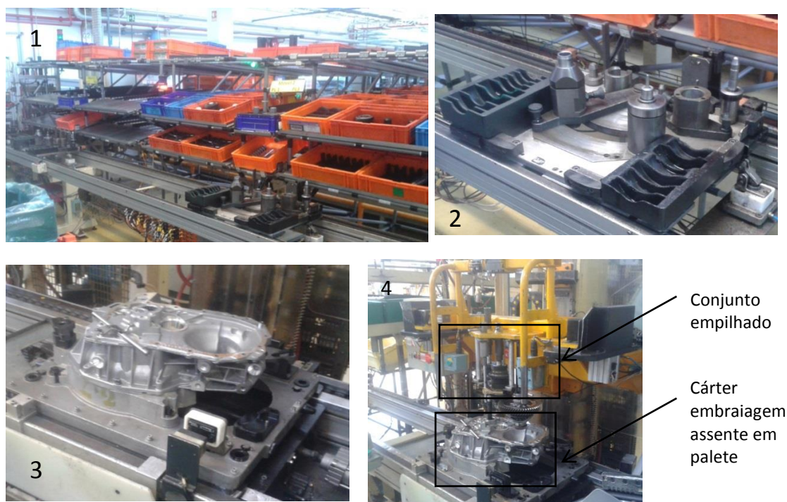
Figura 11- Diferentes zonas e componentes das linhas de montagem do AT5
