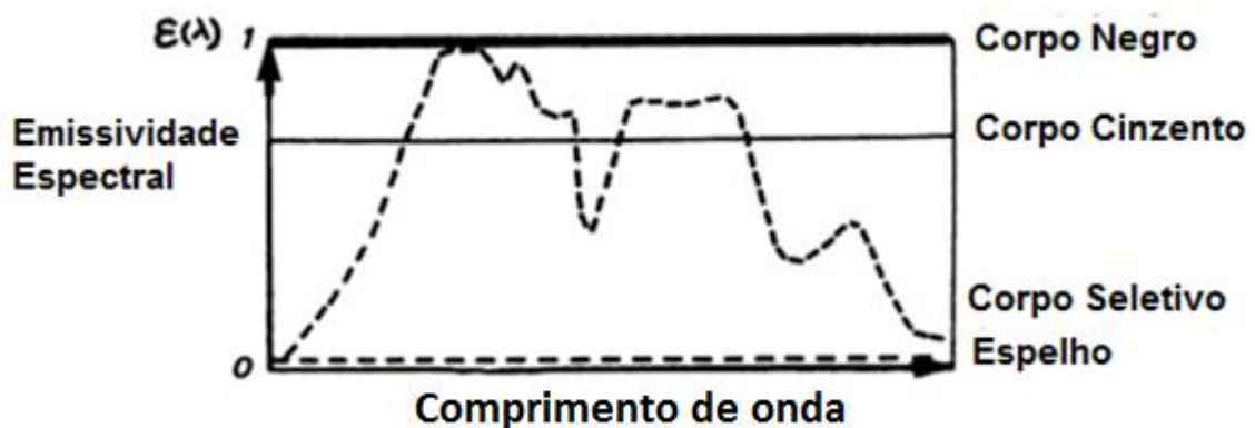
Figura 2.4 – Variação da Emissividade com o comprimento de onda (adaptado de [11])
