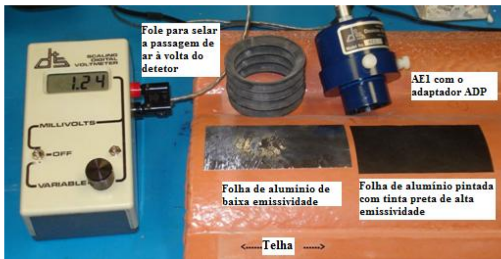
Figura 3.6 – Procedimento para a determinação da emissividade numa superfície cilíndrica usando folha de alumínio (adaptado de [13])
