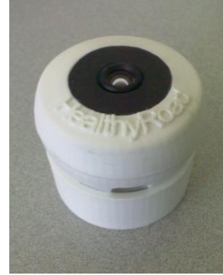
Figura 4.12- Resultado final do encapsulamento para a câmara IDS (solução 2 em ABS)
