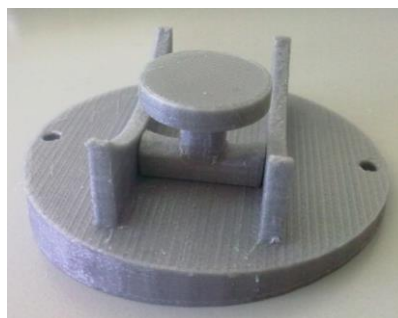
Figura 4.20- Componentes corrigidos no encapsulamento da câmera IDS (solução 2 em PLA)
