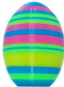
Figura 2.8- Representação da utilização de diversas cores na impressão 3D por FDM (TAMP, 2015)
