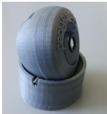
Figura 4.19- Correção da inclinação do encapsulamento para a câmera IDS (solução 2 em PLA)
