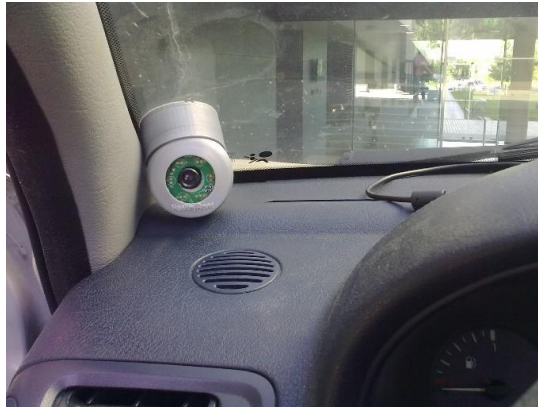
Figura 4.18- Fixação da câmera IDS no veículo (solução 2)
