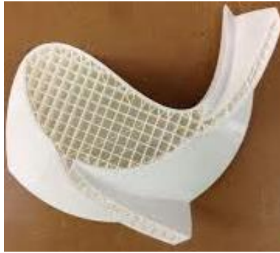
Figura 2.7- Estrutura interna de uma peça semi-oca (Coreprint, 2015)
