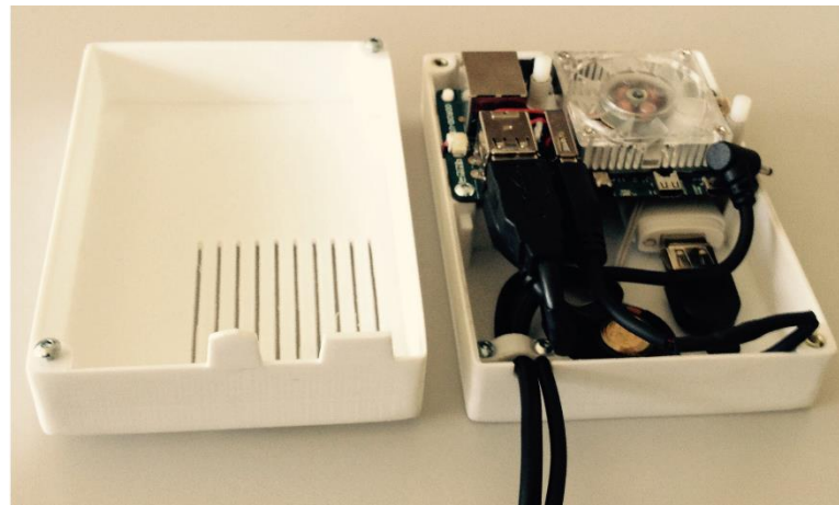
Figura 4.10- Montagem do encapsulamento dos componentes de processamento (ABS)
