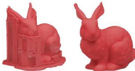
Figura 2.6- Exemplo de uma peça antes e após a remoção dos suportes (Stolten, 2015)
