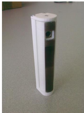
Figura 4.16- Resultado final do encapsulamento corrigido para a câmara e-com Systems (ABS)
