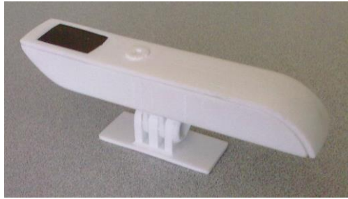
Figura 4.14- Resultado final do encapsulamento alternativo para a câmara e-com Systems (ABS)
