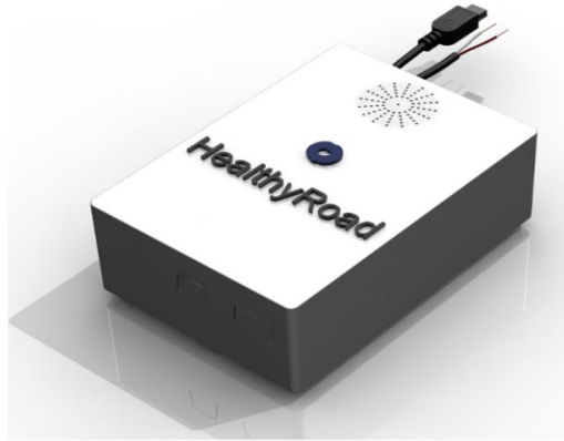
Figura 3.21- Resultado final do encapsulamento dos componentes de processamento
