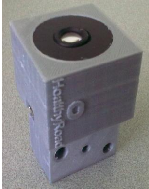
Figura 4.11- Resultado final do encapsulamento para a câmara IDS (solução 1 em PLA)
