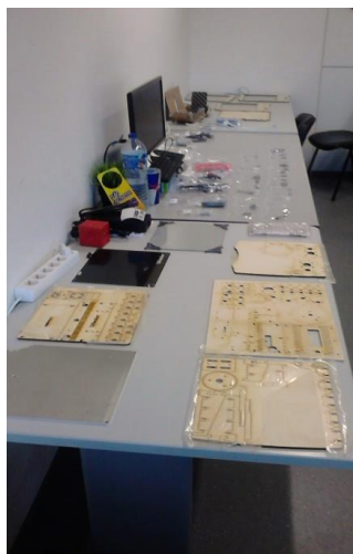
Figura 4.1- Demonstração das peças que constituem a impressora Ultimaker Original Plus
