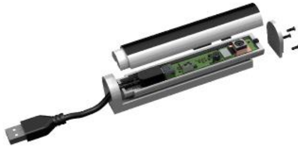
Figura 3.40- Representação do encapsulamento da câmara e-com Systems após melhorias
