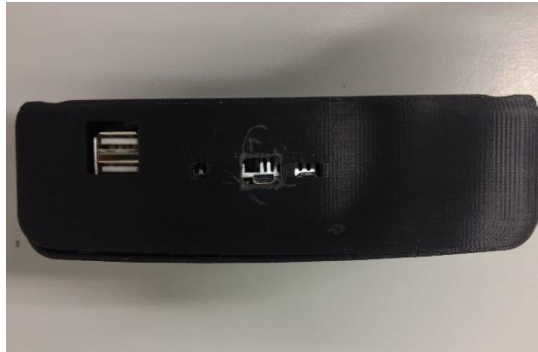
Figura 3.4- Demonstração das ligações laterais de difícil acesso
