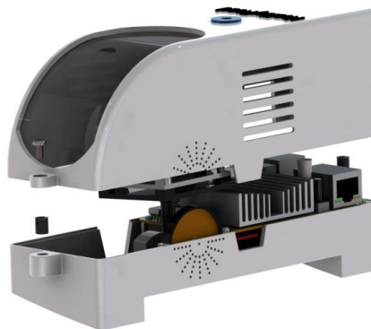
Figura 3.13- Montagem da tampa do encapsulamento completo
