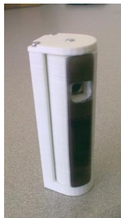
Figura 4.13- Resultado final do encapsulamento para a câmara e-com Systems (ABS)
