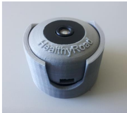
Figura 4.15- Resultado final do encapsulamento alternativo para a câmara IDS (PLA)
