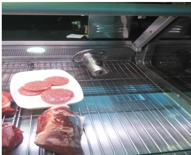
Fotografia 14 – Cabeça de uma picadora de carne colocada no expositor refrigerado após utilização; situação verificada durante ação de vistoria no âmbito do programa PACE (arquivo pessoal)
