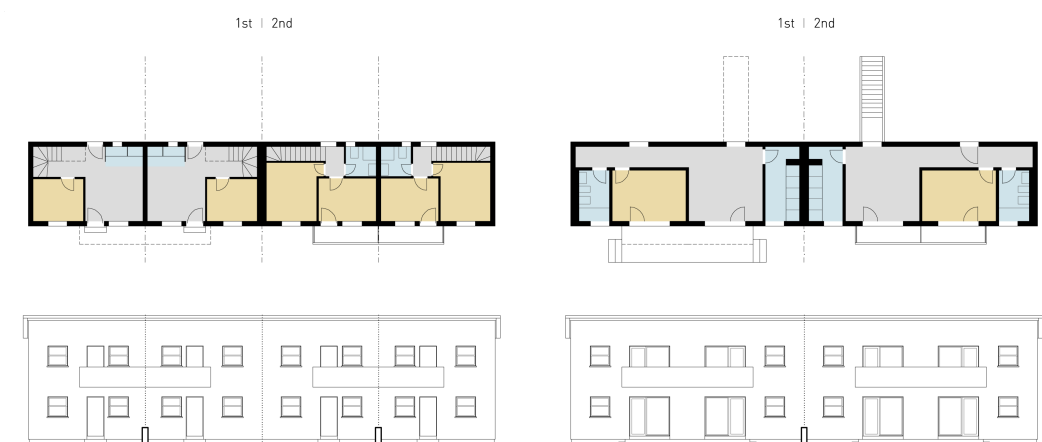
Figura 15: Esquerda: conjunto de quatro casas duplex Tipo4 originais (4xT3). Direita: tipologia da proposta de renovação (4xT1). (Fonte: adaptado a partir das peças desenhadas do projeto)
