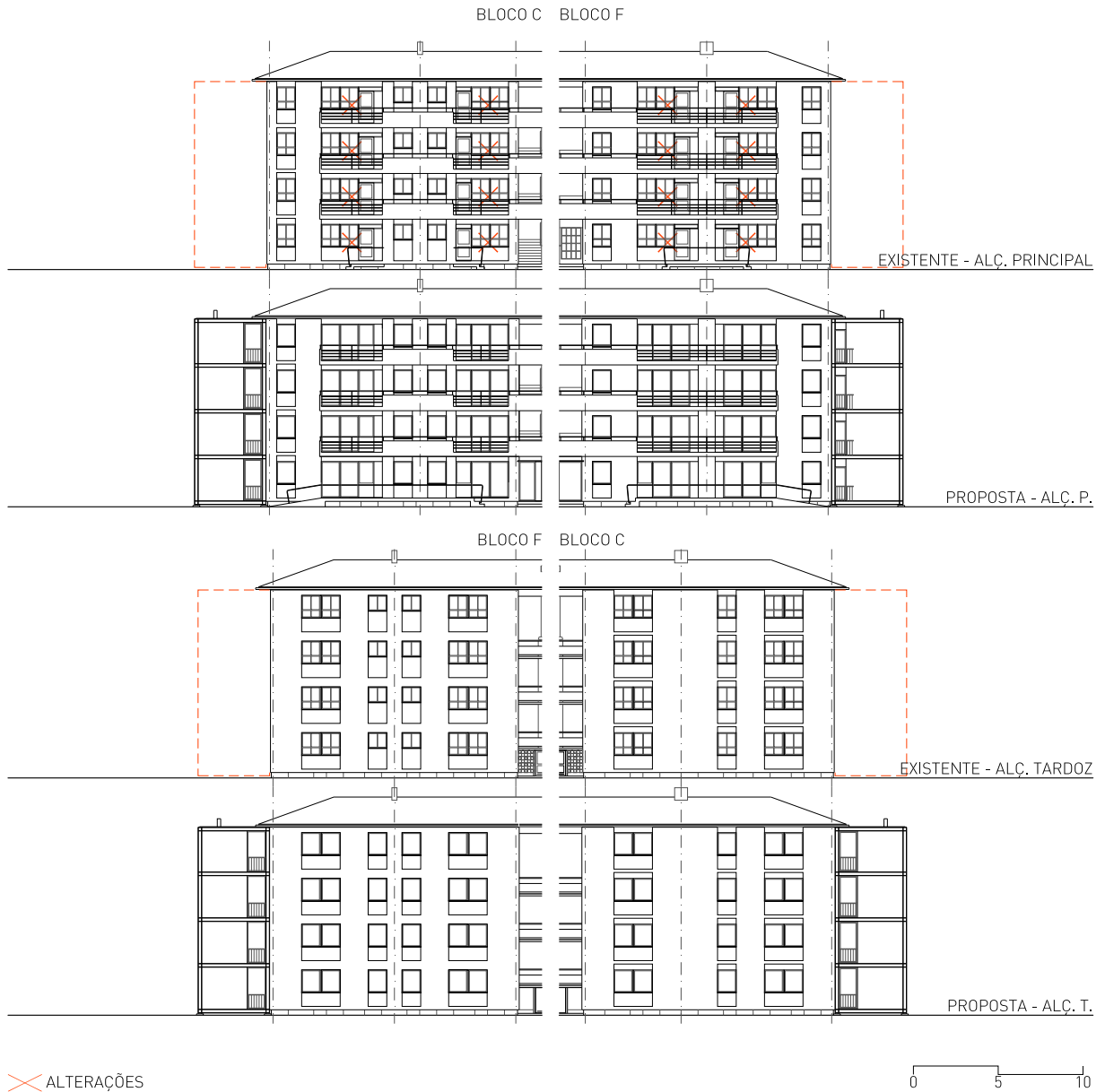
Figura 56: Bairro de Pio XII, 1958. Proposta de renovação: alteração de fachadas. Alçados – Blocos C (esq.) e F (dta.)
