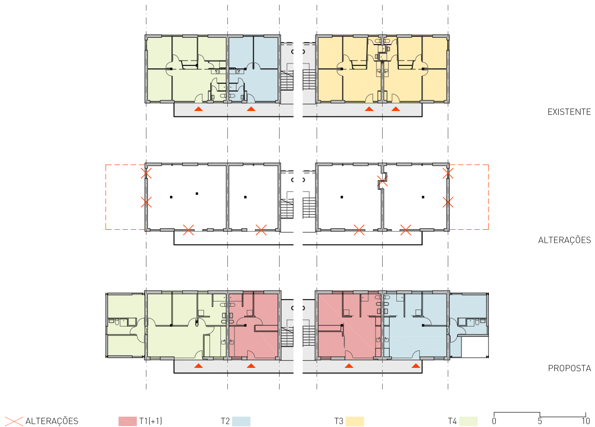
Figura 54: Bairro de Pio XII, 1958. Proposta de renovação: alteração de tipologias. Plantas – Blocos C (esq.) e F (dta.)
