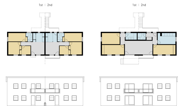
Figura 14: Esquerda: conjunto de duas casas Tipo3 originais (4xT3). Direita: tipologia da proposta de renovação (2xT3). (Fonte: adaptado a partir das peças desenhadas do projeto)
