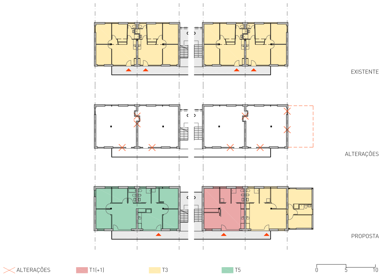
Figura 48: Bairro de Pio XII, 1958. Proposta de renovação: alteração de tipologias. Plantas – Bloco A
