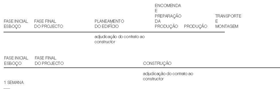
Fig.98 Comparação do tempo das operações de planeamento e construção entre um edifício de madeira segundo os novos sistemas (em cima) e um de betão.
