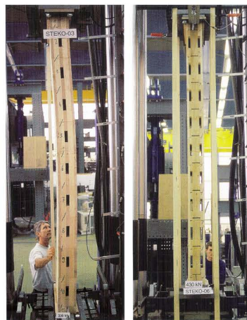
Fig.14 Elementos Steko a serem testados no laboratório da ETH Zürich.
