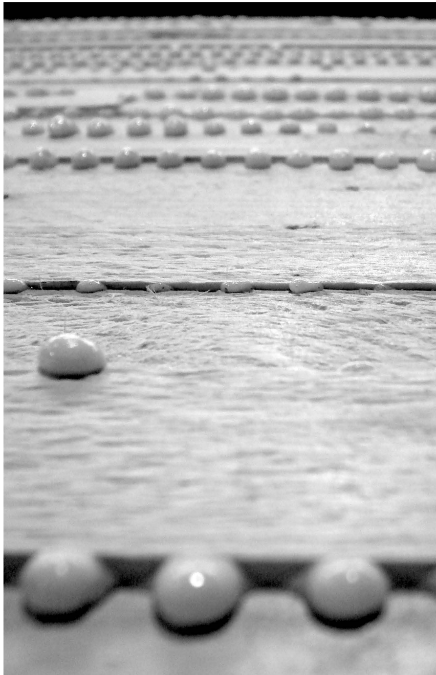
Fig.07 MADEIRA LAMELADA COLADA. SECAGEM (SCHILLIGER).
