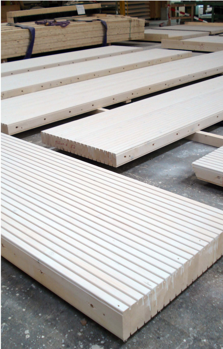
Fig.17 ELEMENTOS FIXOS TRANSVERSALMENTE, SCHILLIGER HOLZ, 2008.
