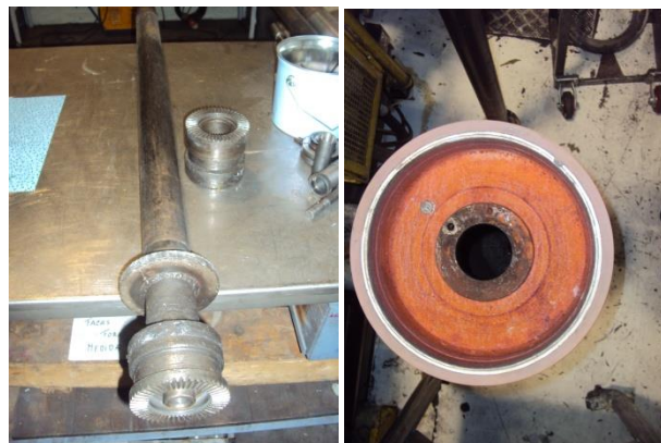
Figura 9. Sistema de acoplamento atual. a) Veio com acoplamento, b) zona de encaixe do veio no rolo de aplicação.
