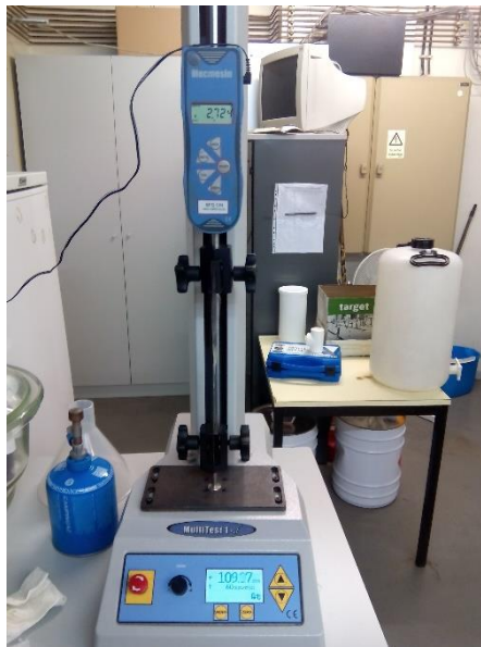
Figura 22. Instalação utilizada para medição de aderência.
